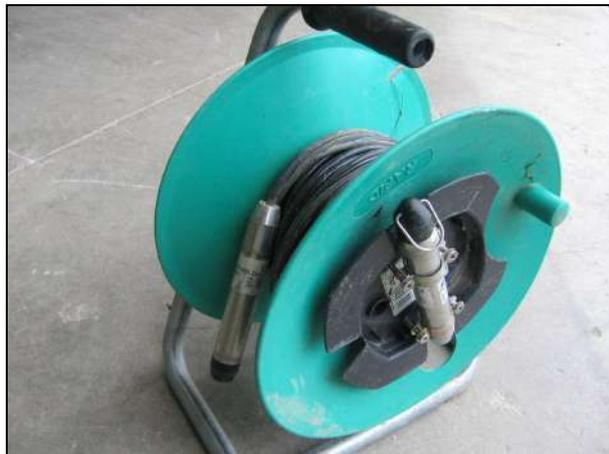
Figure 10 : Capteurs de pression : STS DLN70
